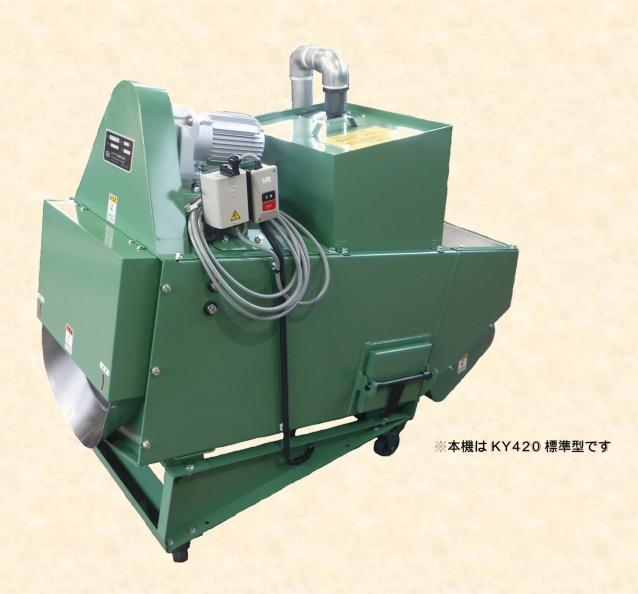
鋸盤・スリ割機・ねじ立盤・自動盤・両端機・フライス盤・ナット盤ほか、 各種機械から加工された製品の洗浄に威力を発揮します!
